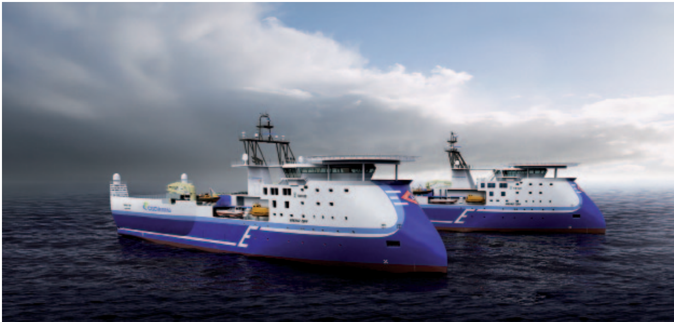
Den høyteknologiske offshoreflåten er viktig både for norsk skipsfart og norsk verftsindustri og gir virksomhet på mange små steder særlig på Vestlandet. På dette bildet ser vi to seismikkskip av typen TBN XBow Sx 120 som Ullstein Verft skal levere til Eidesvik Offshore ASA på Bømlo, det første sommeren 2010, det andre høsten 2011. Skipene blir på 11 900 brutto registertonn og 5330 tonn dødvekt. Foto Eidesvik Offshore ASA.
